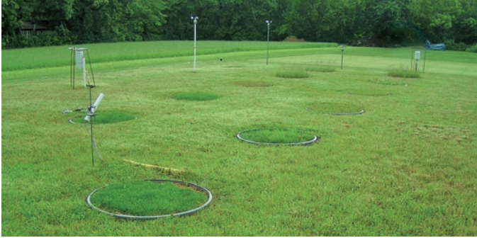
Lysimeteranlage der TU Berlin in Berlin-Wilmersdorf, Messung von Niederschlag, Versickerung und Verdunstung, Rasenfläche auf Bodenart Podsol und Braunerde, simulierte Grundwasserstände 1,35 und 2,10 m (s. Abb. S. 12)
