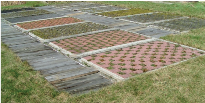
Lysimeteranlage am gleichen Standort zur Messung des Wasserhaushalts von teilversiegelten Oberflächenbefestigungen, u.a. durchlässiger Asphalt, Rasengitterstein, Betonverbundpflaster (s. Abb. S. 12)
