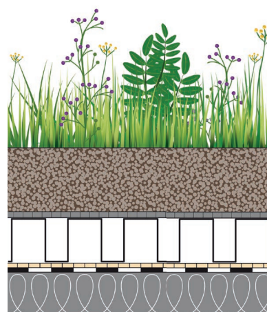
Extensive Dachbegrünung in mehrschichtiger Bauweise
