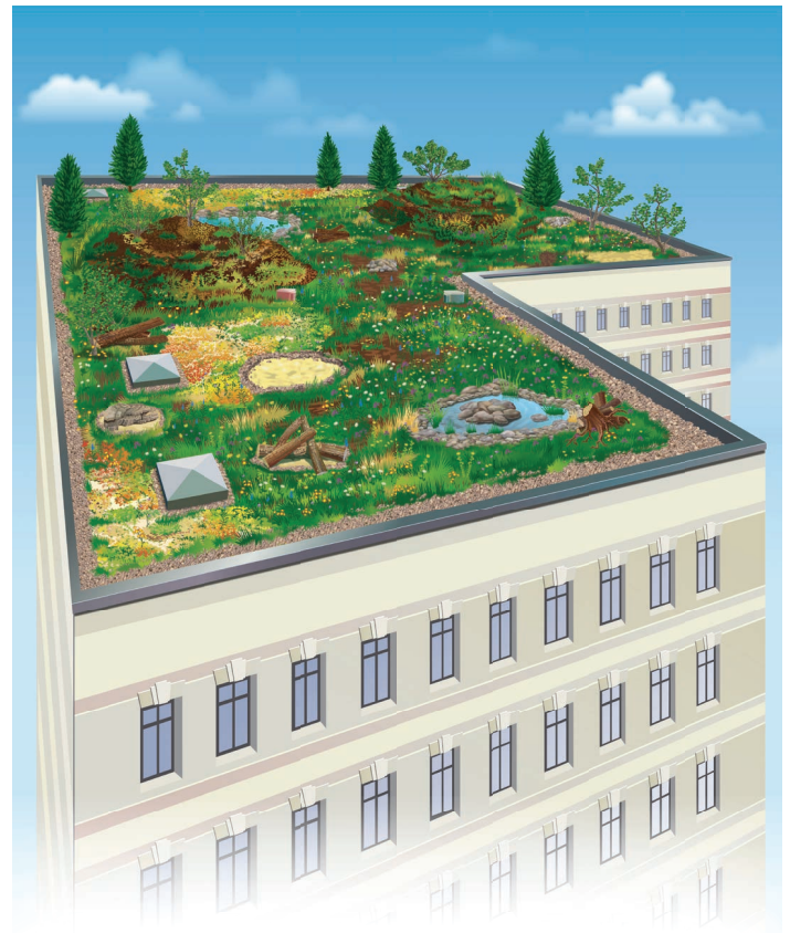
Beispiel für den Einsatz von Biodiversitätsbausteinen auf Gründächern
