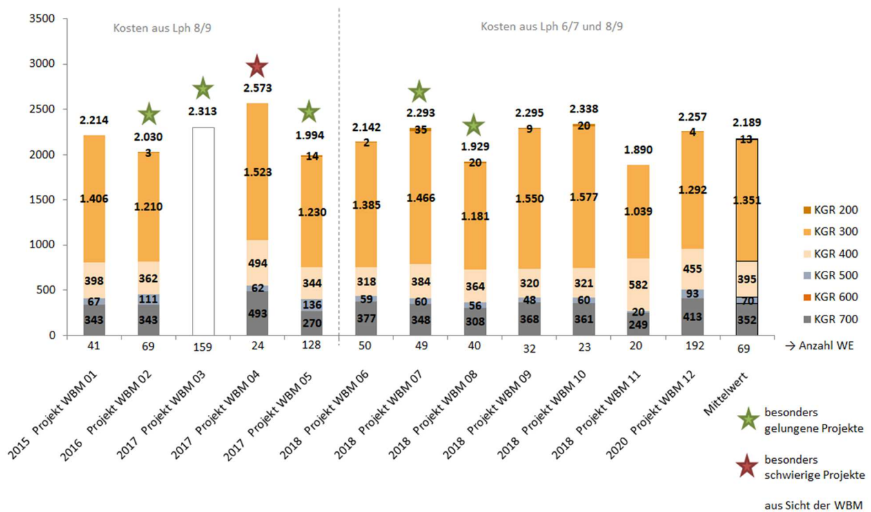
Abbildung 33: Herstellungskosten (KGR 200-700) der Projekte der WBM sortiert nach Baubeginn innerhalb der Fertigstellungsjahre (dargestellte Jahreszahl); Angaben in €/m 2 Wohn- und Gewerbefläche; N=12
