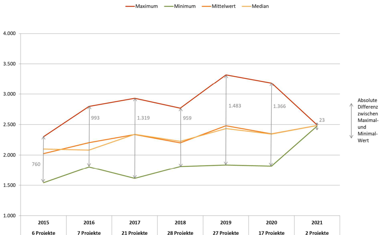
Abbildung 53: Herstellungskosten (KGR 200-700) der Projekte der LWU nach Jahren; Angaben in €/m 2 Wohn- und Gewerbefläche; N=108
